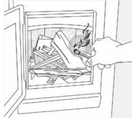
Cargue 3 o 4 palos de leña sobre las astillas, para así formar una buena cama de brasas. La altura máxima de llenado en la cámara son 50mm bajo el templador.
