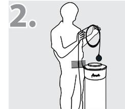
2. Deslice la bola desde el extremo superior de la chimenea hasta que aparezca dentro de su estufa a leña. Desmonte el templador en proceso inverso, explicado en el capítulo "Colocación del Templador".
